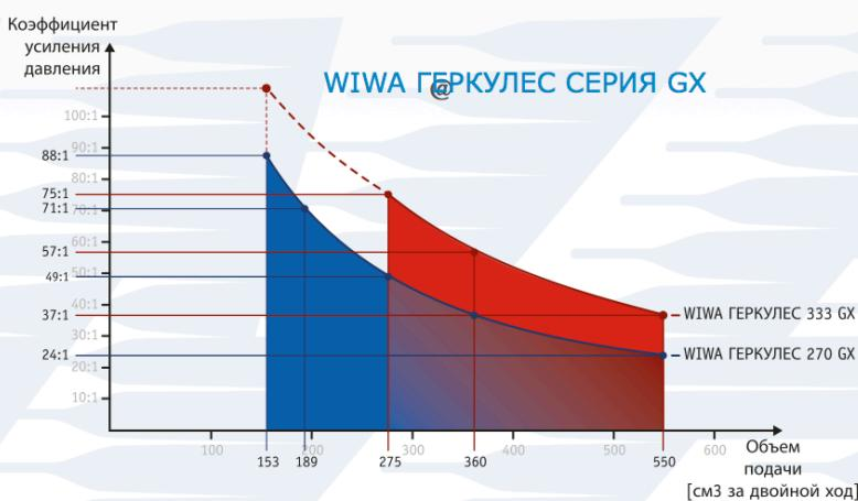
На графике отображены значения объемов подачи для каждого аппарата при заданном коэффициенте усиления давления. У аппарата **WIWA ГЕРКУЛЕС 333 GX** объем подачи выше при том же самом коэффициенте усиления давления.
